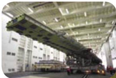
► A380 alas para pruebas de fatiga Broughton Reino Unido (Fatiga Alas) y sección de fuselaje y ensamble interno.
