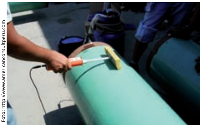
Detección de Partes descubiertas y microporos con Equipo Elcometer 270 de voltaje variable 67.5 / 90 v, con señal audible. Recubrimiento del Tipo Epóxico, con espesor de película seca promedio de 16 mils.
