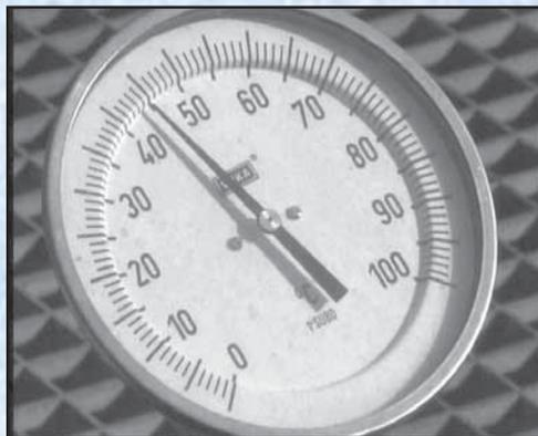
**Figura 10.5** Errores de paralaje y de interpolación
