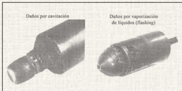
Figura 8.9 Daños por cavitación y flashing
