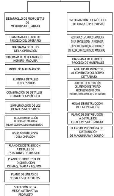
Figura 2.2 Modelo integral para el diseño, desarrollo y/o mejora sistematizada de métodos de trabajo en un sistema productivo, utilizando las técnicas de la ingeniería de métodos.
