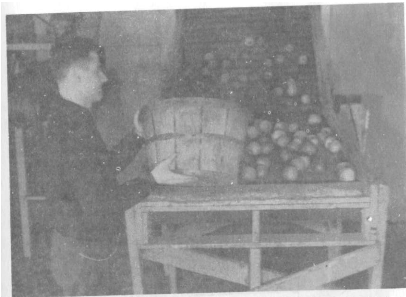
Figura 34. Los canastos con manzanas se vacían en el transportador de banda. (Cortesía de William E. McIntosh Company.)
