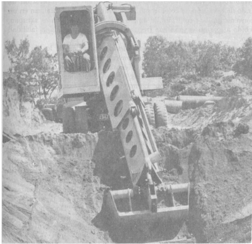
figura 55. Caso en el que el operador tiene una visibilidad excelente de la situación que él controla. The Warner and Swasey Company's Gradall. (Cortesía de la Warner and Swasey Company.)
